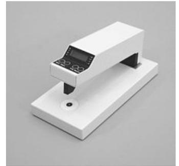
Aujourd'hui, l'opérateur est remplacé par une cellule. On se passe dans ce cas des deux sources lumineuses et on se contente de la source de référence. Cette dernière peut être intégrée au densitomètre ou faire l'objet d'un dispositif spécial, par exemple une table lumineuse. Le signal électrique généré par la cellule exposée à la lumière, après amplification, est mesuré par un milliampèremètre gradué en densité.
